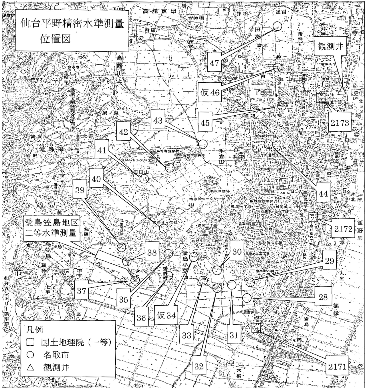
平成 24 年度測定地点の分布と沈下状況（仙台平野精密水準測量・国実施分）
