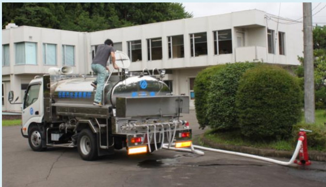
消火栓から給水車のタンクへ水を補給
